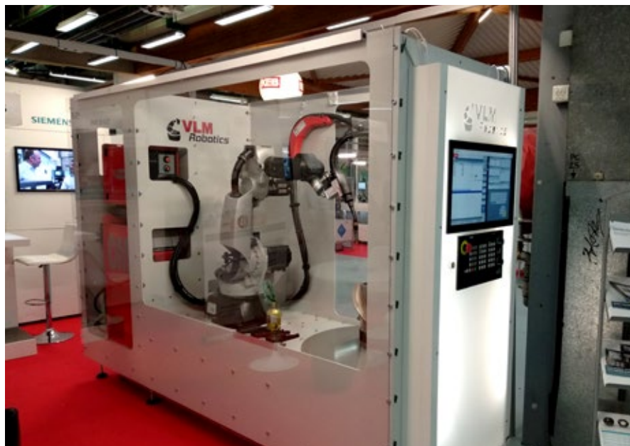
Machine Comp@tq de fabrication additive métallique ; développée dans le cadre d'un PIA Nouvel Aquitaine (NC Siemens, robot COMAU , logiciel NX ... )
