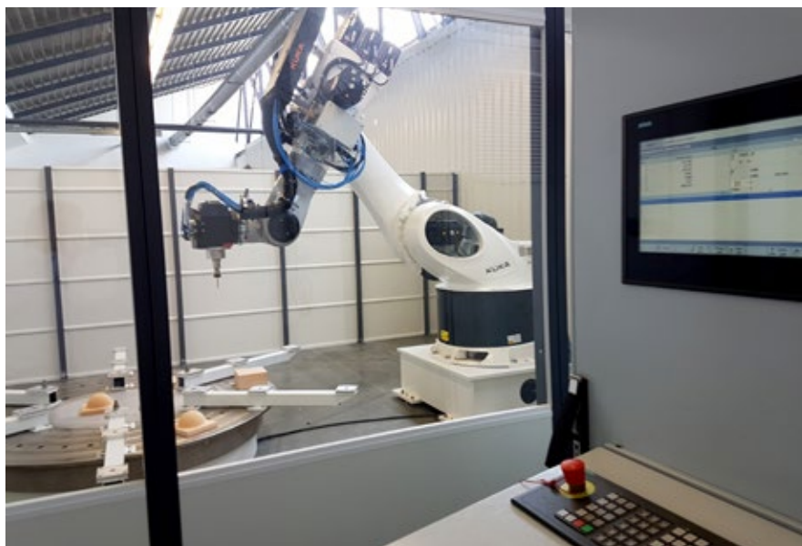
Cellule d'usinage multifonctions de pièces en composite (jusqu'à 4 m de diamètre) de Nimatech.
